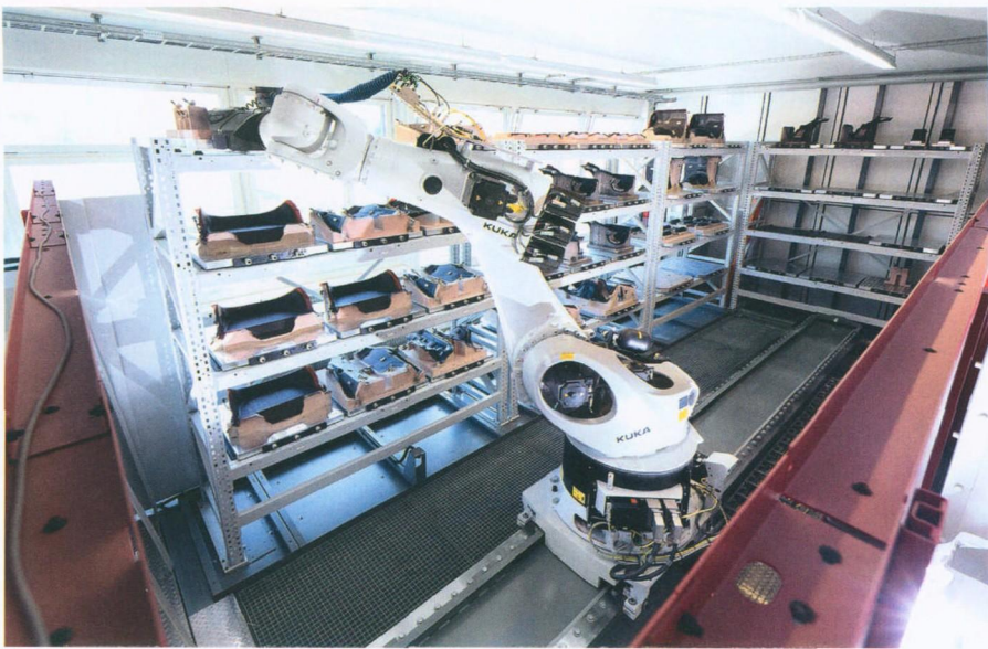
图 2 RS3 机器人和刀具库系统一览图，由带抓握的机器人和三个附加的，总共 43 个托盘的架块组成
