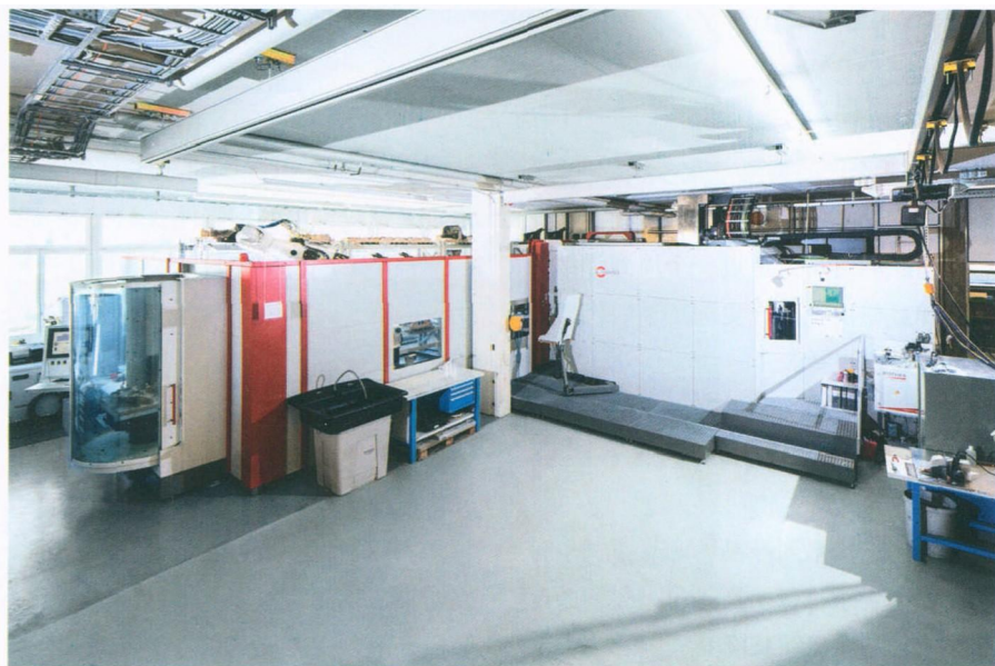
图 1 C50U 的加工中心（右边）以及相关 RS3 机器人和托盘系统（左边）的灵活生产系统，最左边是托盘存储位置
