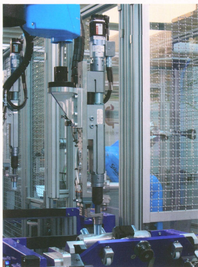
图2 两个装有拧紧轴的 Scara 机器人接管拧紧螺纹工作
