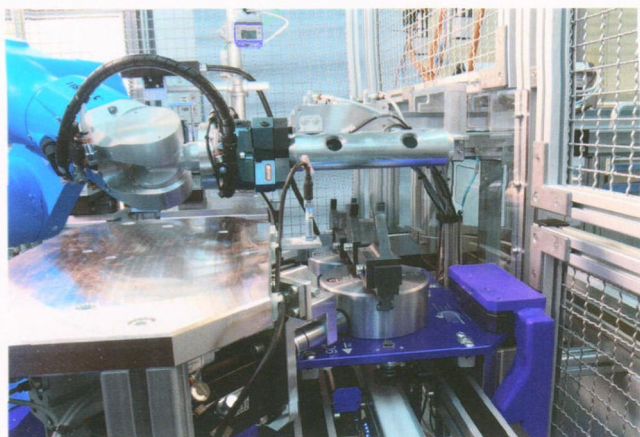
图1 史陶比尔六轴机器人 TX60 用其内部夹具抓起一个基体
