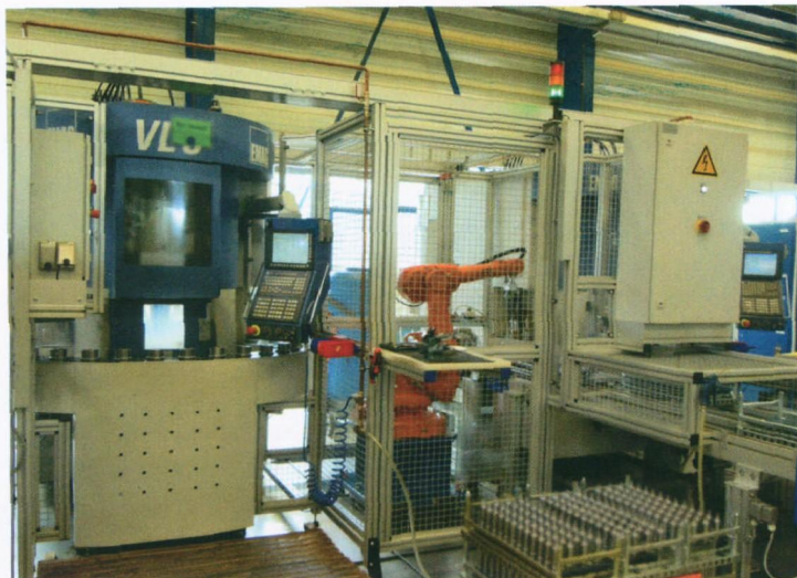
图 1 这里可视设备部分的核心部件是机器人装载和卸载
