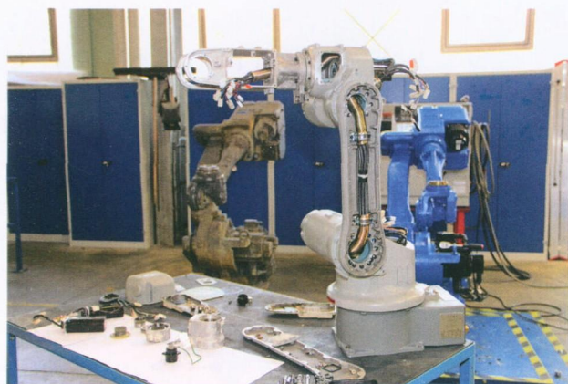
图 1 更换新的内部线束在彻底检修时是最基本的
