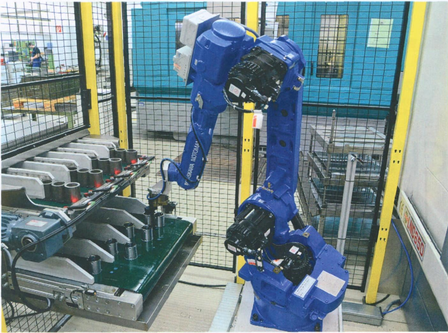
图 2 六轴机械手从上方的四条送料带上取出未加工工件，并将成品放到出料带上
