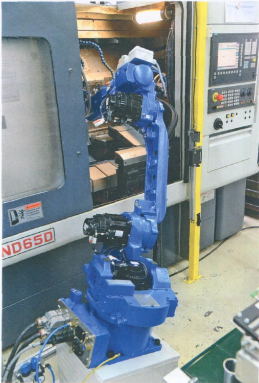
图 3 将机械手安置在底座倾斜的设备前端的一侧可发挥车床最佳使用性能
