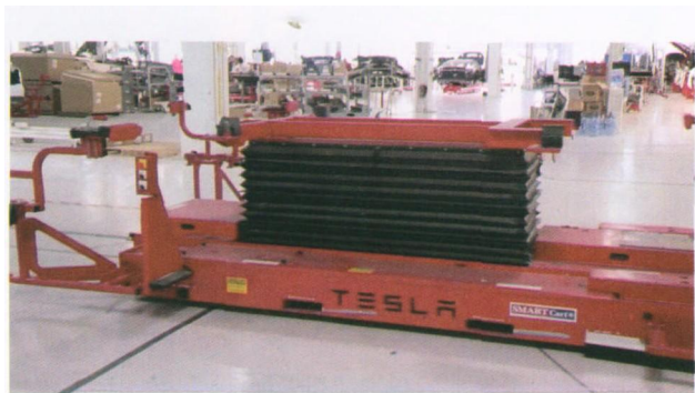
图 2 对于 Tesla 无人运输小车的安全防护，SICK S300+Flexisoft 安全控制器的组合也同样发挥着其突出的优势
