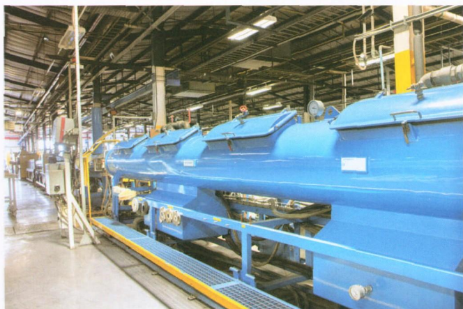
图 1 在 Radius Systems，为挤出生产线提供动力的传统直流电机正逐渐被交流电机代替，这旨在提高能效，降低维护成本和噪声
