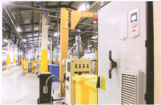
图 5 经证明，SynRM 电机和变频器成套装置在 Radius Systems 挤出生产线的恒转矩应用中与在泵机和风机等二次转矩应用中一样有效
