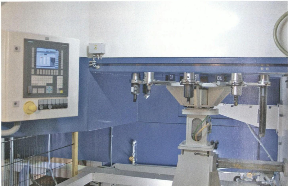
图5 换刀装置增加了复合机床的灵活性
