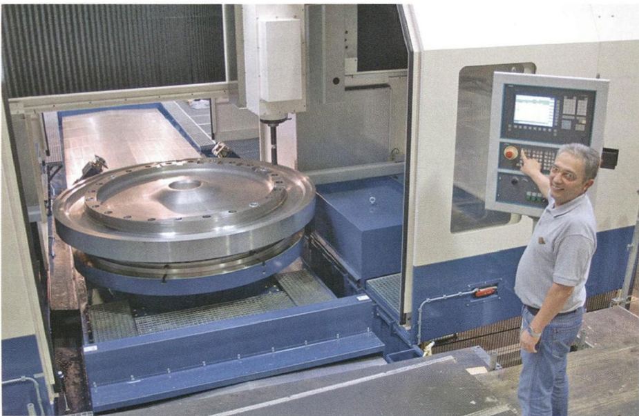
图4 复合机床 GantrylineRT 铣削加工
