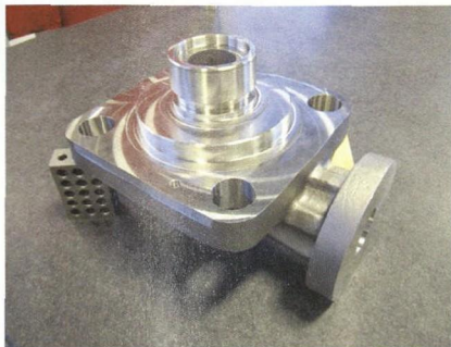
图2 此零件为使用直角头加工的理想候选零件
