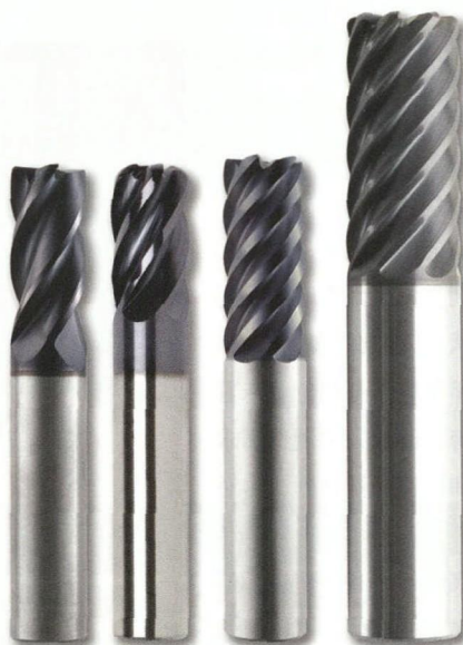
图5 图中三个较小的端铣刀分别有四个、五个和六个出屑槽。进行刀具与工件接触面积较大的操作编程时，应选用较少出屑槽的铣刀。若允许采用较小的接触面积时，可采用较多出屑槽的铣刀
