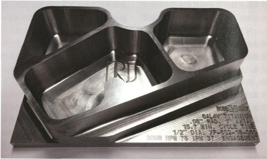
图 1 要加工这块仅有雪茄盒大小的钛金属工件对于现在的加工中心来说并不是难事
