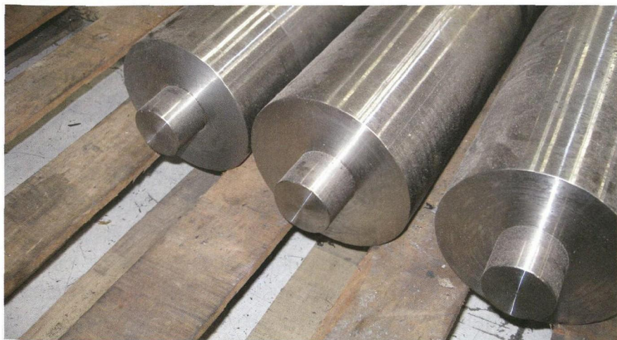
图 5 通过车削对圆柱杆进行加工。对此功能的需要解释了为何闸阀在开始时是棒料，尽管它们最初的形状是矩形
