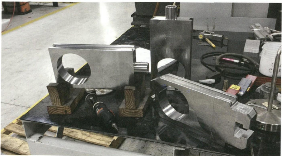
图 3 在上面的照片中可以看到不同式样的闸阀零件。采用高速进给铣刀，为每个这样的零件粗制外形，并加工大孔
