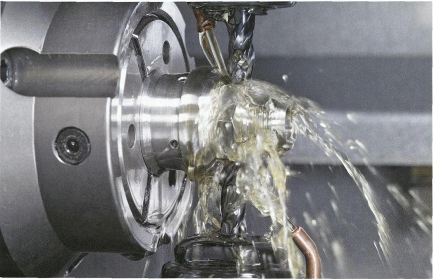
图 2 通过采用 Performance Bio NC Lite 冷却润滑剂，金属切屑的破断状况得到明显改善
