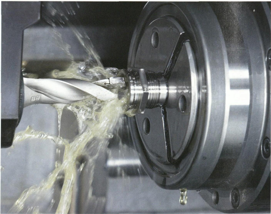
图 1 以新一代原材料为基础的疏水型冷却润滑剂可以使润滑油嘴加工镗刀的使用寿命延长 600%
