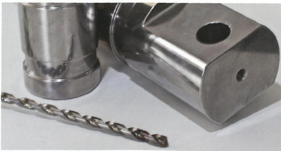
图 2 不显眼但又至关重要的因素：高强度钢制摇臂轴纵向钻孔，Walter Titec DC170 Supreme 致强系列钻头采用单次不间断走刀，钻孔精确快速
