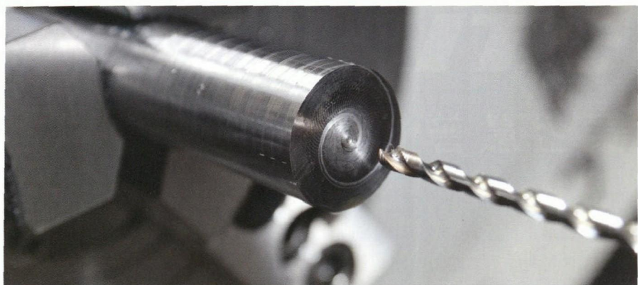
图 3 Walter Titec DC170 Supreme 致强系列钻头：钻头只需一个小导孔，贯通整个材料，即使钻削最坚硬的钢材，也不需要啄钻
