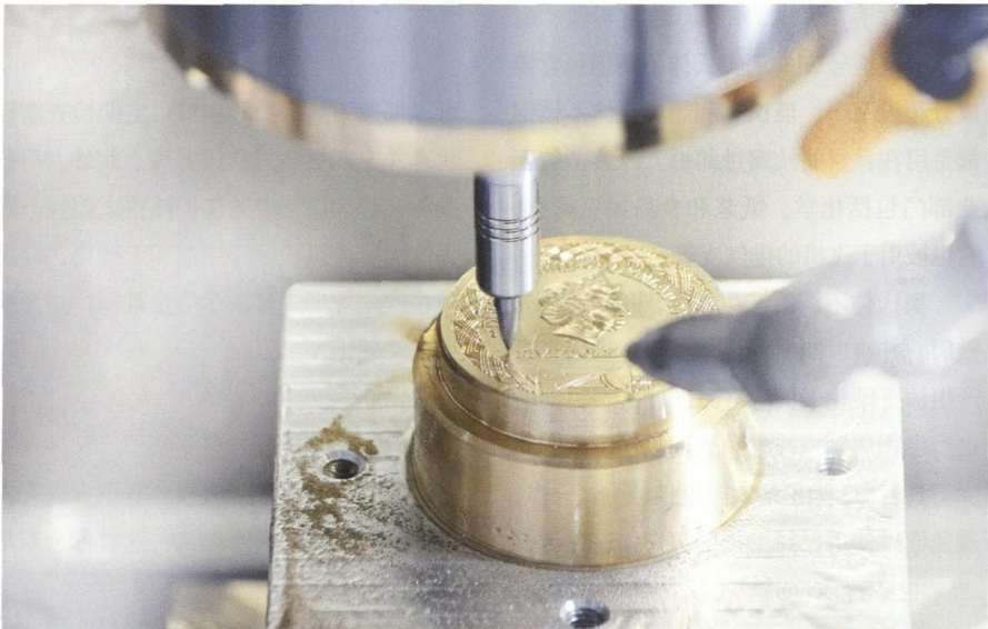
图 1 在模具制作中，将超精密机加工中心和雄克 TRIBOS 三角刀柄结合起来可获得完美的表面加工效果
