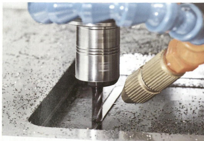
图2在硬币冲压的过程中，将空气轴承主轴和超细平衡雄克 TRIBOS 三角刀柄结合起来可产生非常好的效果
