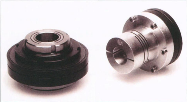
图 2 安全联轴器 SIK 采用了简单的球摩擦传动原理，为驱动系提供了可靠的过载保护
