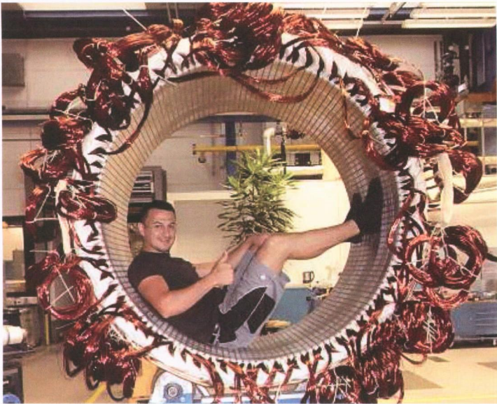
图 2 Oswald 公司研发生产的第二大 TF 系列大扭矩电动机 TF77，装配后的直径约 1.5 m，连续工作时的输出扭矩高达 100 000 Nm
