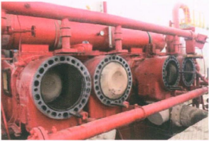
图 4 动力端活塞燃烧室灰分均匀，气缸壁没有明显磨损
