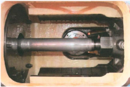
图 5 十字头连杆润滑良好，无明显磨损
