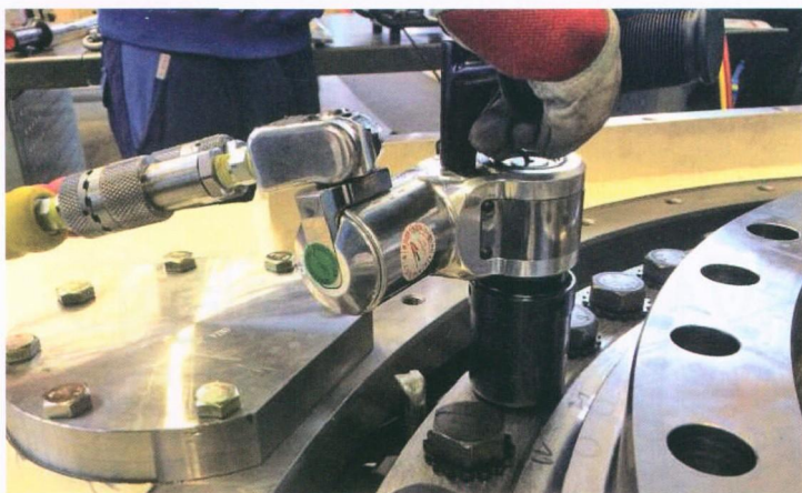
图 2 如果是在狭小空间内拧紧，没有反应力臂的拧紧优势明显
