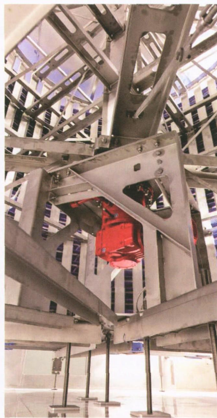
图2 Arctic a10 型螺旋管冷冻系统的设计是按照多班次工业化生产需要设计的，冷冻柜内食品冷冻情况的监控和驱动装置的变频控制以及运动零部件数量的减少都保证了其工作运行的可靠性
