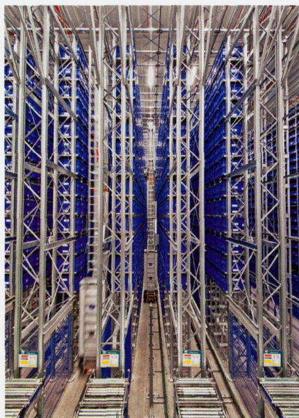
图 4 AKL 利用率高，有故障紧急应急方案，两台货架操作装置能处置同一货架的货物
