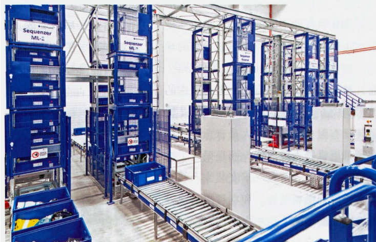
图 3 每条生产线有一按序列连续供应材料的系统，对电缆端分线容器进行预先分类
