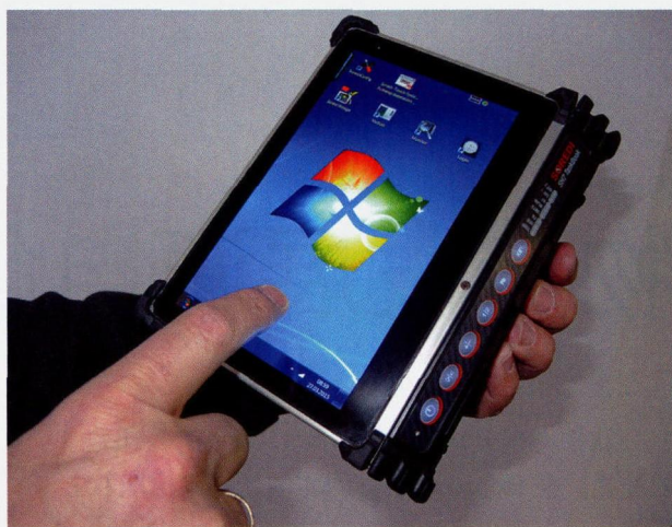
图2 Soredi有限公司研制的SH7手持式智能装置的7 in显示屏的淡入式键盘有足够的尺寸大小,方便使用者识读和确保操作的高精准度
