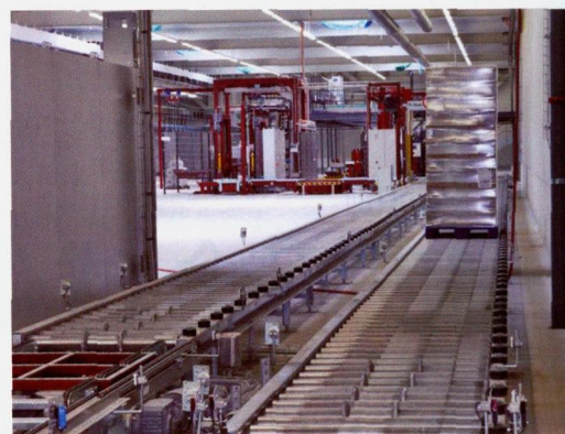
图2 装满咖啡的纸箱离开生产卫生区域后，被放入生产车附近木质托盘，然后输送轨道将托盘驶离生产车间
