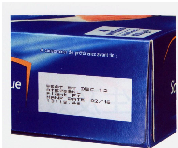
图2 喷码质量保证解决方案是一个强大的可追溯性系统的子集，它可以将喷码机与集中式数据库集成起来，使机器操作人员可以在产品转换过程中从大量保存的编码中进行选择
