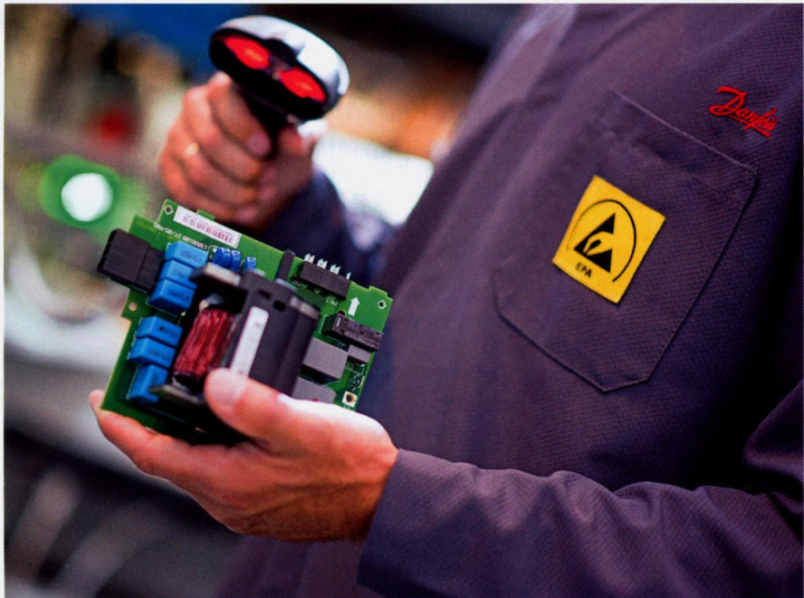
图 1 通过条形码或 RFID 芯片可识别和跟踪每个组件。这样一来，这些工作站可以清楚地了解应该如何对产品进行装配
