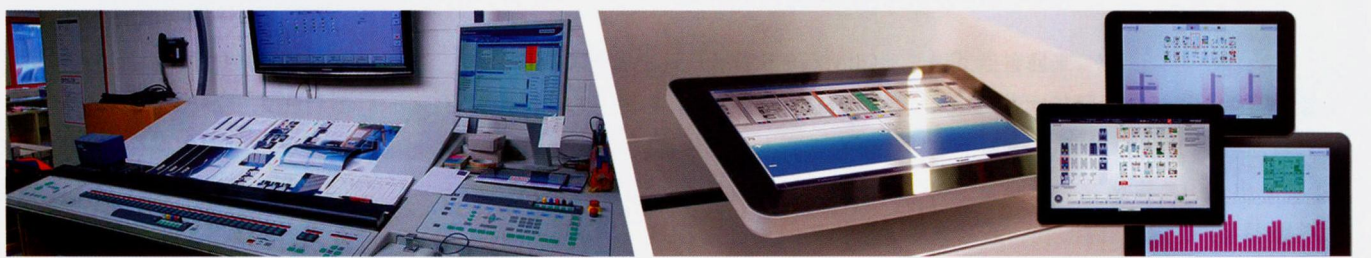
图2 昨天的操作界面(左)对比今天的操作界面(右), Colorman e: line 印刷机采用触摸屏集中监视所有的生产过程
