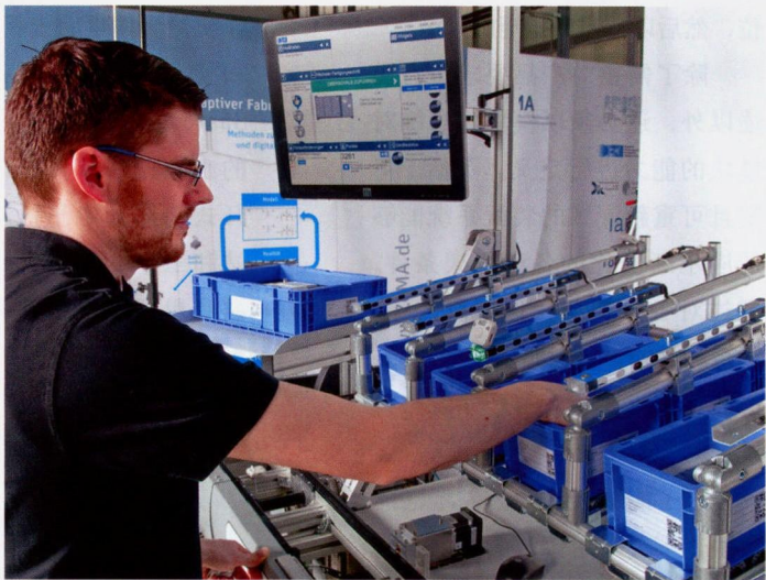
图 3 第一站将根据不同的产品来传输不同的组件 (借助 Pick-by-Light 系统)，并对其进行装配
