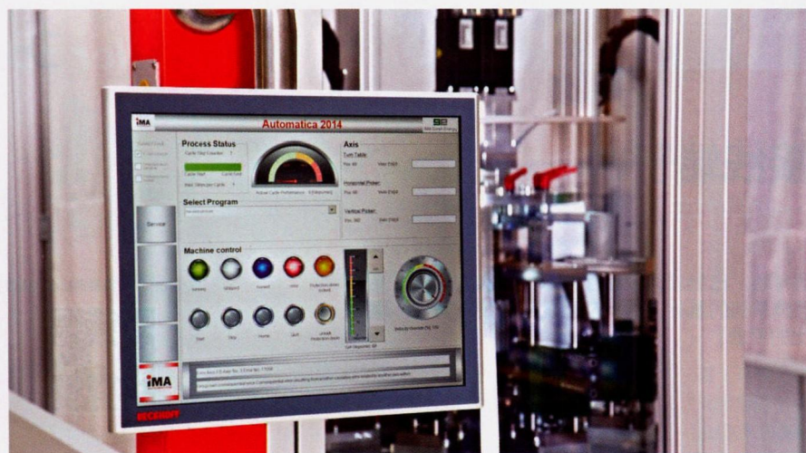
图 1 Beckhoff 公司的 IPC 控制操作面板一目了然，提供了所有重要参数和转动冲程设备的状态
