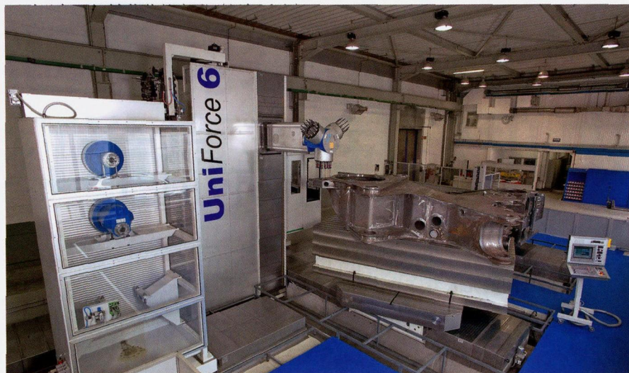
图 2 SHW UniForce 6 型可更换铣头机床通过采用多个主轴头对一个设备部件进行加工
