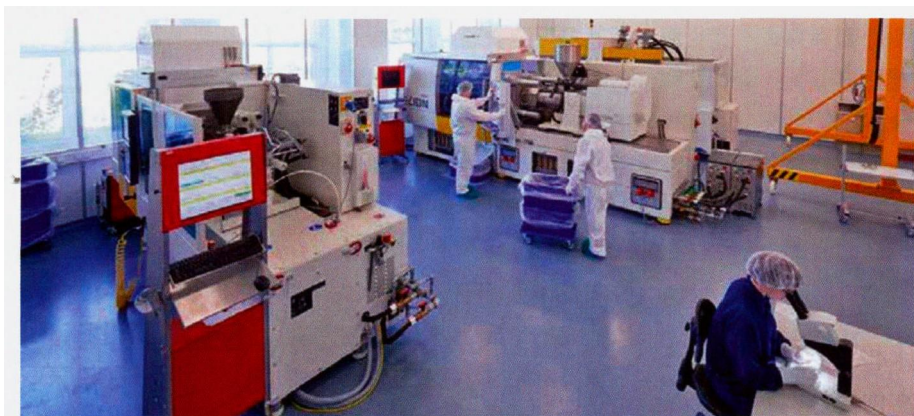
图 2 个性化医疗技术要求单件精准和经济的加工。Gerrsheimer 公司拥有一条达到批量生产质量的小批量生产线
