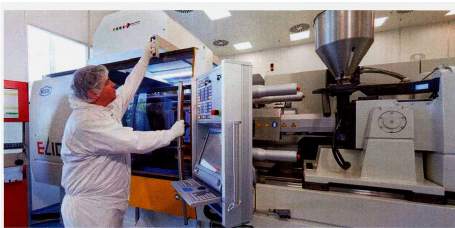
图 4 集成的 Laminarflow 罩使注塑范围内环境清洁度达到 7 级
