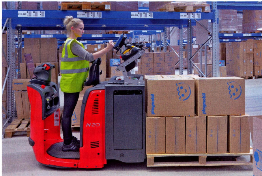
图2 Linde N20系列低位拣选叉车的驾驶员座椅护板可调性高,装货平台为全消振结构形式,装有防滑橡胶垫板,这便能够在驾驶拣选和处理货物时提供舒适的作业条件
