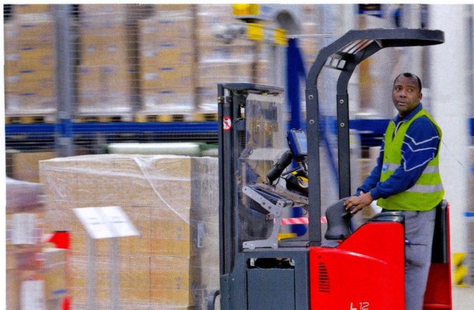
图4在 Playmobil 物流中心里, Linde L12 LSP 系列高位拣选叉车是通用型设备。例如,使用该系列高提升货物车可为载货汽车装货或卸货,也可用作该物流中心各个厅之间的货物运输
