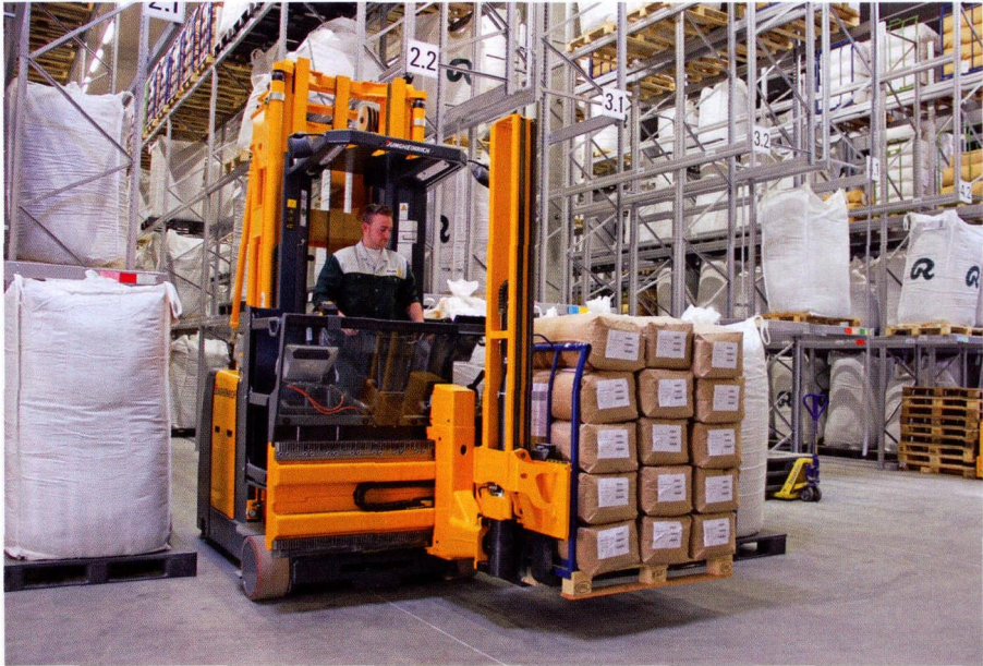
图 7 Jungheinrich EKX 513 型结构系列的窄巷道叉车将装有草本植物的口袋的托盘运送到预备作业区的货物周转位置
