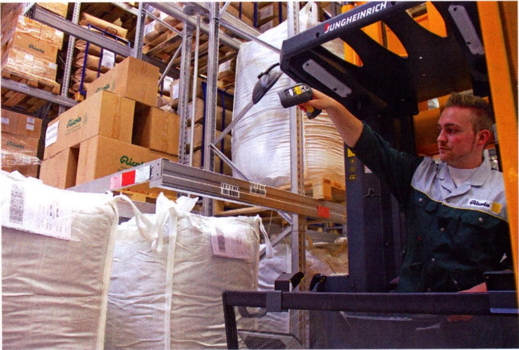
图 6 驾驶员正在扫描托盘条形码，库房管理系统将通知驾驶员应在哪个托盘周转位来库存该托盘
