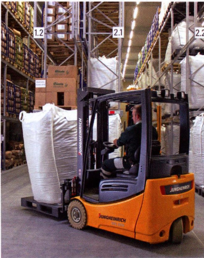
图 5 对于半成品生产过程中的供料也就是为检疫库房、草本植物切割机和混合装置供料，该新物流中心库房使用的是 EFG 216K 型 Jungheinrich 三轮电动叉车
