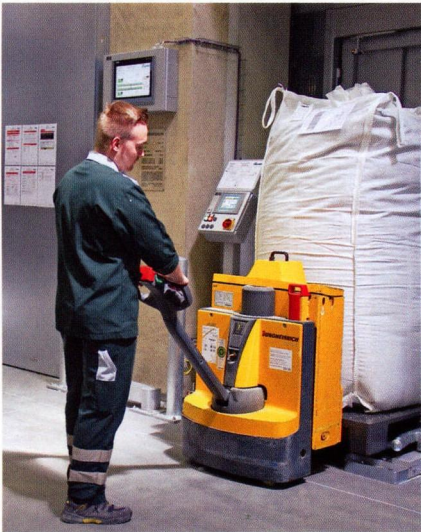
图 4 EJE C20 型 Jungheinrich 电动低举升装卸车将托盘放置在输送技术装置上，该输送技术装置将 Ricola 公司的新物流中心与设置在旁边附属建筑物内的糖果生产点连接起来
