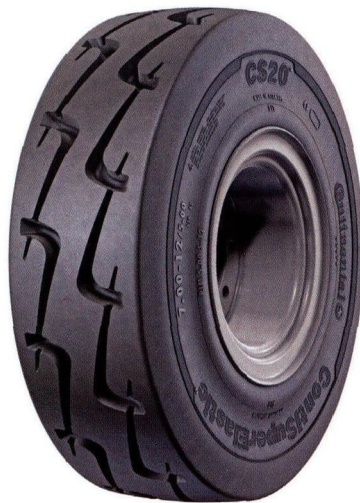
图 2 采用新的 6.00-9/4.00、7.00-12/5.00 和 7.50-15/5.50 规格的新截面尺寸的 Continental CS20 系列实心轮胎，可满足在机场上进行作业的行业牵引车的使用要求
