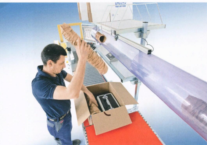
图2 “Paperplus Chevron” 包装材料直接在工位上生产制造，并用机器有效的将其放置在硬纸箱里
