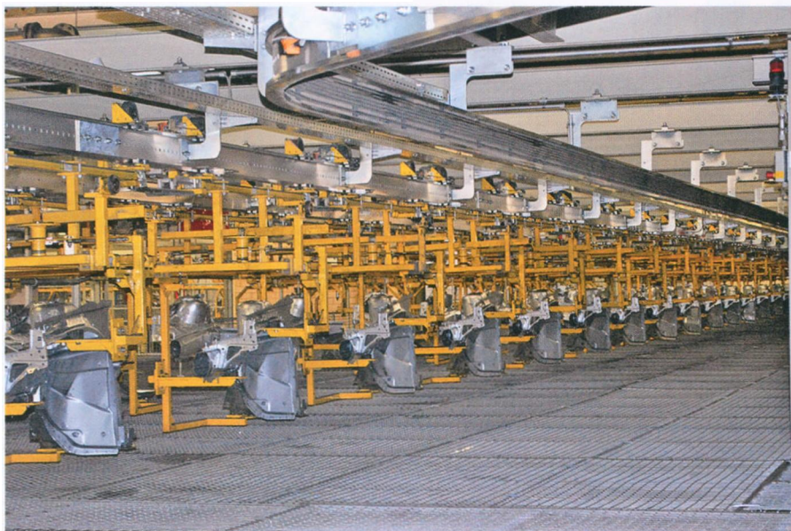
图2 为了在 EHB 里识别汽车车身配件，Ford 公司在其位于 Saarlouis 的汽车生产厂里安装使用了 Sick 公司研制的 RFU620 读写器
