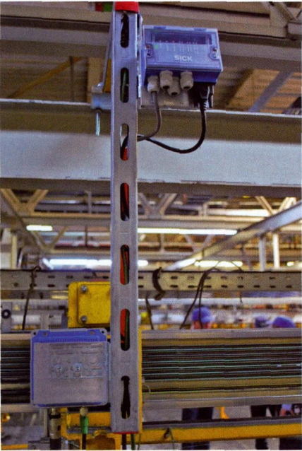
图 3 沿着诊断部门的车辆行驶线，当下 RFU620 读写器处于高频率范围，最大作用范围可达到 30 cm
