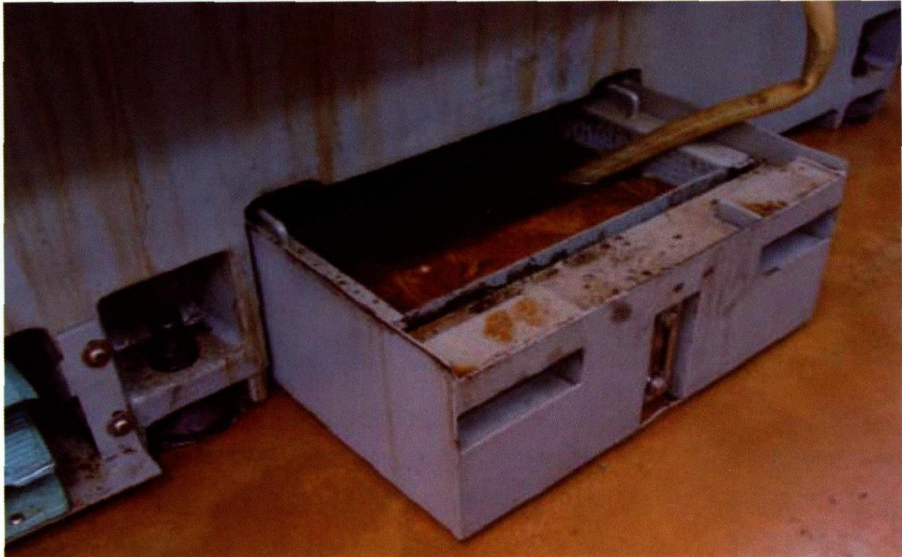
图 1 深圳亿和的加工设备出现了导轨油流失现象
