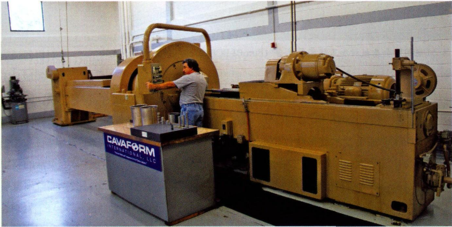
图 1 旋锻机基座为厚度 4 in 的混凝土垫板，用来保持精度和对正。George Hastick 操作该机床有 20 年了，他能通过监听工艺声音变化来判断何时拉出坯件并检查成型是否完成
