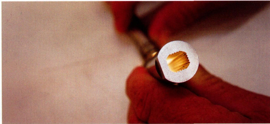
图 3 正如左侧坯件证明的那样的，该工艺能加工出具有狭窄肋部和其他复杂几何形状的模具，所花时间比 EDM 工艺要少得多
