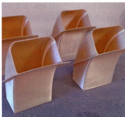
图2 Zare 公司在套 Stratasys Fortus-3D 生产系统上直接制造出空调设备的进气管和排气管
