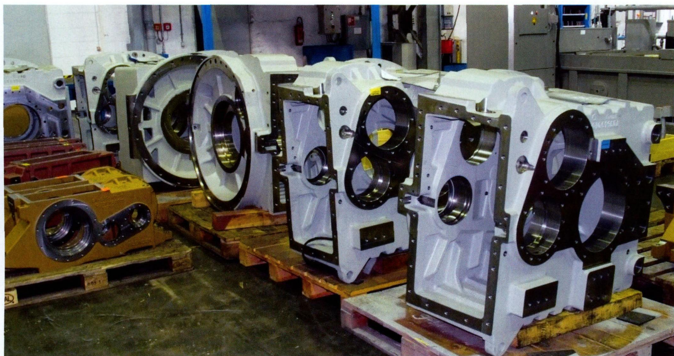
图 1 有轨车辆用齿轮箱。专业铣刀最适合加工大型铸铁零件连接面
