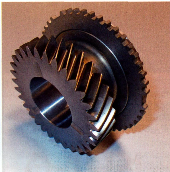
图 2 粉末冶金制成的 6 档传动齿轮，其应用在一个手动变速器上
