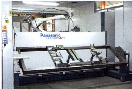
图 5 Otto Kind 购买的 Panasonic Performanc System 含有一个 PA-H 框架，可以用来焊接最大长度为 3000 mm 的组件
