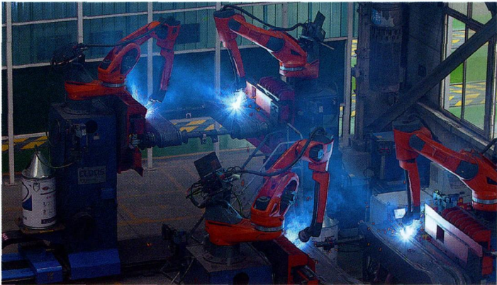
图 2 总共 25 台机器人设备用于生产液压支架侧护板的底部和连接组件
