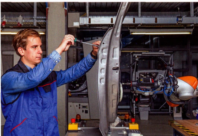
图 5 机器人与工人同时在装配台完成不同的任务
