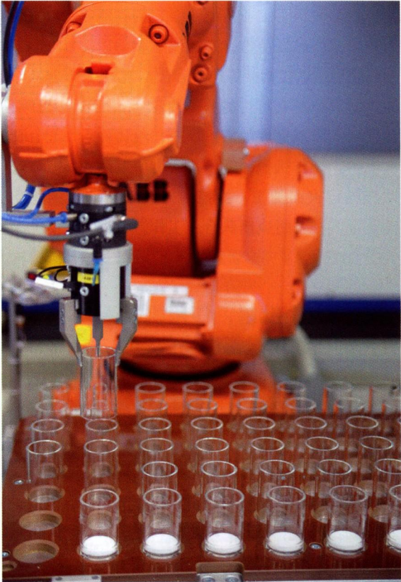
图 5 由机器人技术支持的生产流程支持不间断的加工操作，可以熔化和个性雕刻硼硅过滤
