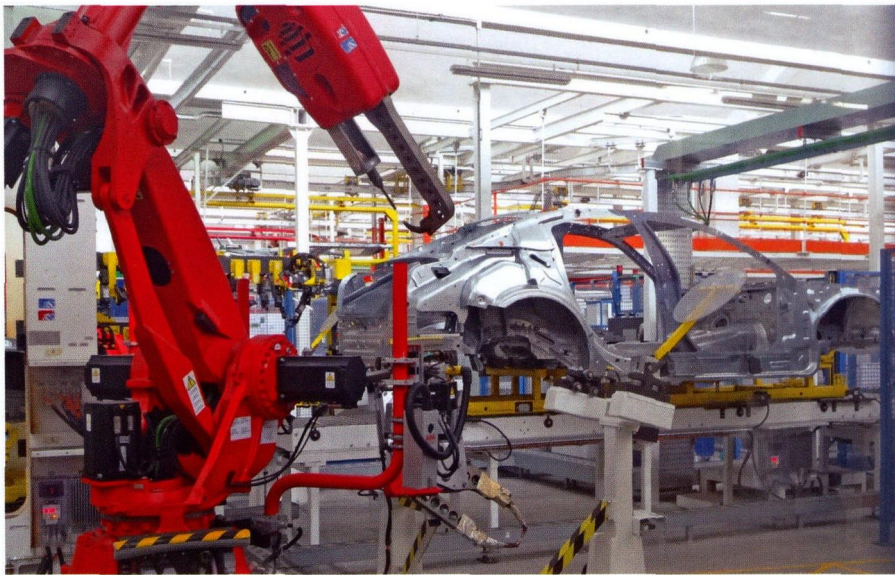
图 2 机器人型号为 Comau Smart NJ2 的是一台焊接机器人，用于固定车身零件。大多数在金属板加工阶段的工作机器人都是关节机器人
