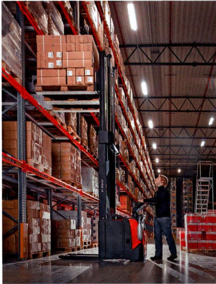
图 3 新研制的 BT-Staxio 系列电动堆高车结构紧凑，使用范围广，货物的提升高度最大为 6m，承载能力高且具有特有的提升和下降速度
