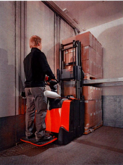
图 2 BT-Staxio-P 系列电动堆高车共有从载重量为 1.2 ~ 2 t 的 11 个不同型号，是专门为载货汽车货物装卸作业和库房、配送中心以及销售行业的使用而研发的
