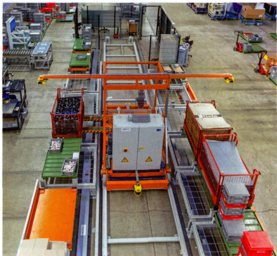
图1 该移动式输送系统的全部动作均由激光扫描装置进行全程监控
