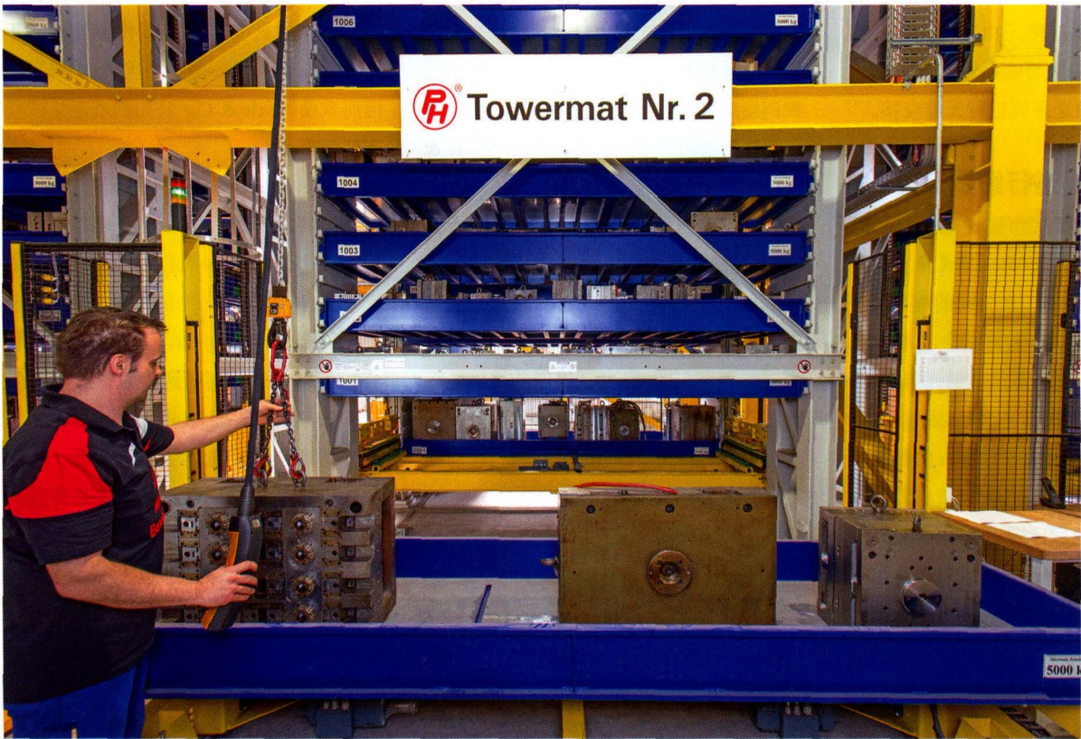
Paul Henke 有限公司只需按动电钮，便可按照“货到人”的规则自动化的将压铸件工件输送到生产作业现场
