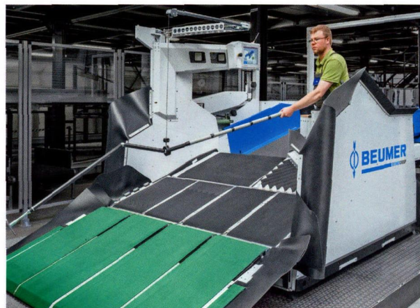
图 2 使用 Beumer 公司研制的包裹拣选设备，操作人员可高效率的卸下传送带上的包裹
