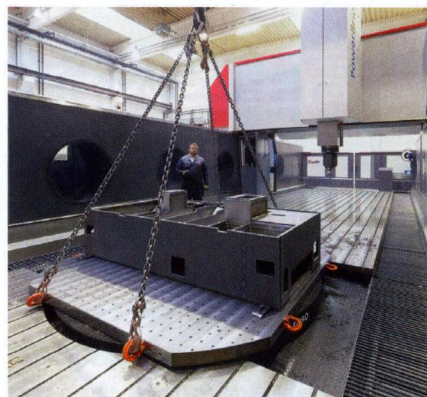
图 3 在主加工时间内，吨级重量的零件已同时在机床之外的工件托盘——圆工作台上夹紧，几秒钟内精确对准
