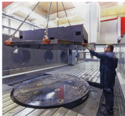
图 2 在龙门铣床的底座上涉及到两个相互独立的机床，一个在圆工作台上加工，另一个在长型床身上
