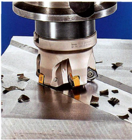
图 2 模块化刀具系统可选择各种不同的可换式铣刀头
